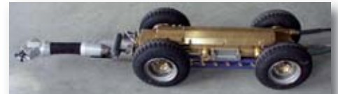
Kanalkamerawagen zur Überprüfung der Kanäle
